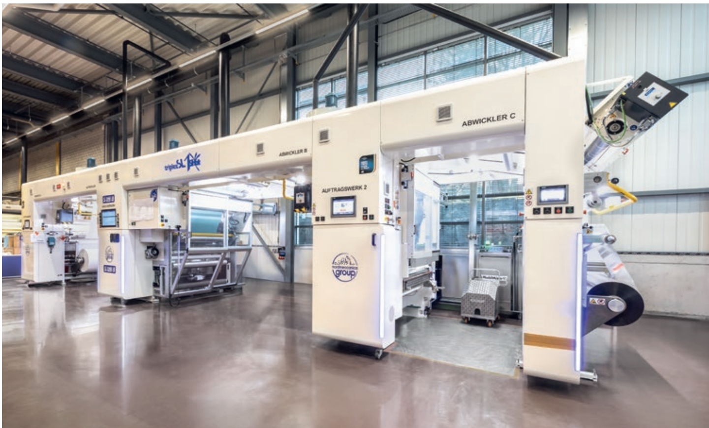
Neue lösungsmittelfreie Kaschieranlage der Wipf AG.
